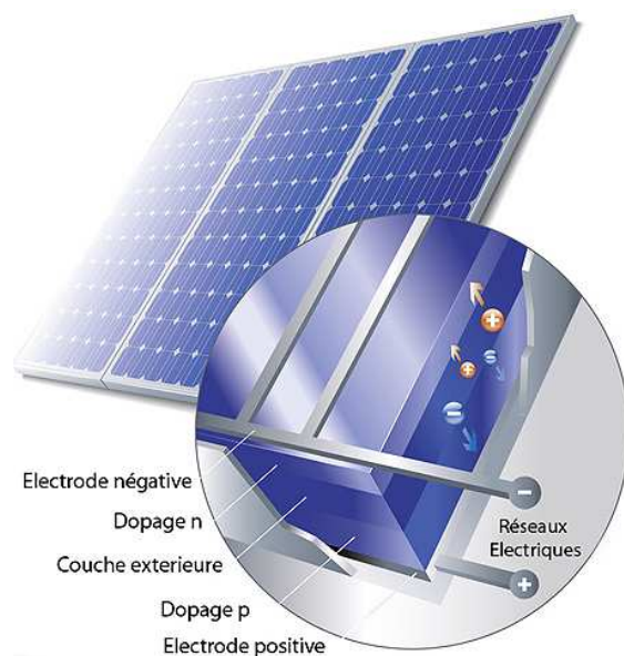
Figure 9 : Principe de fonctionnement d'une cellule photovoltaïque
