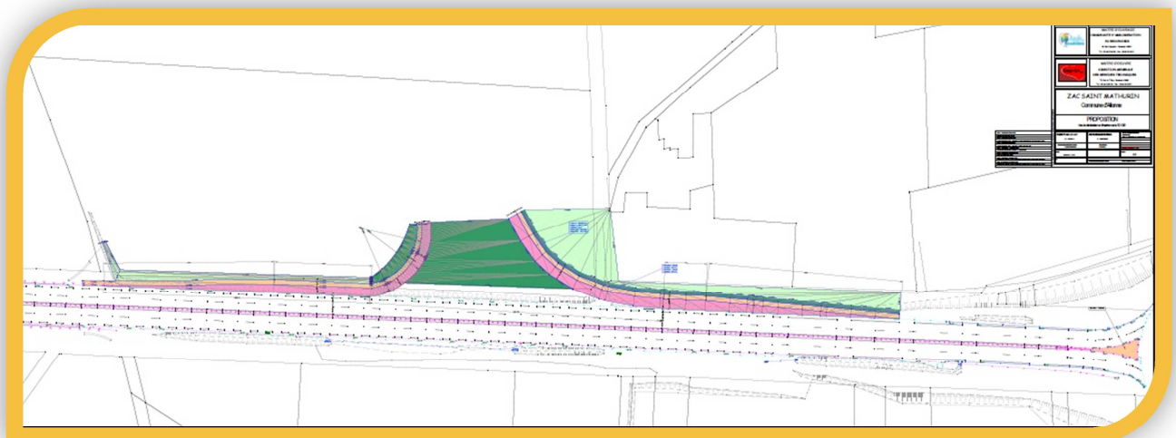
Projet de plan pour la voie d'accélération et de décélération
