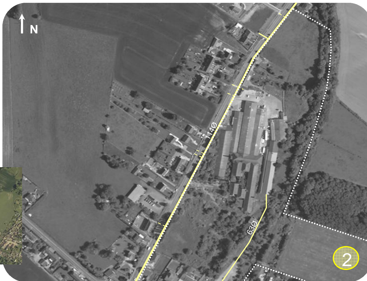
Figure 17: Localisation des réseaux gaz aux abords de la zone de projet
