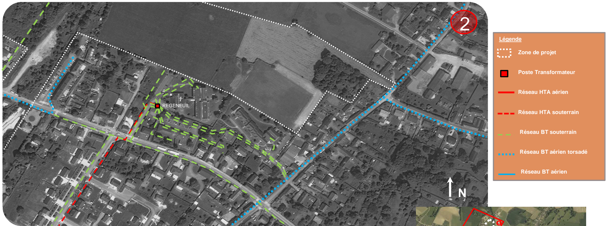
Figure 14.: Localisation des réseaux électriques aux abords de la zone de projet
