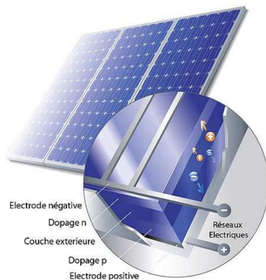
**Figure 9 : Principe de fonctionnement d'une cellule photovoltaïque**
