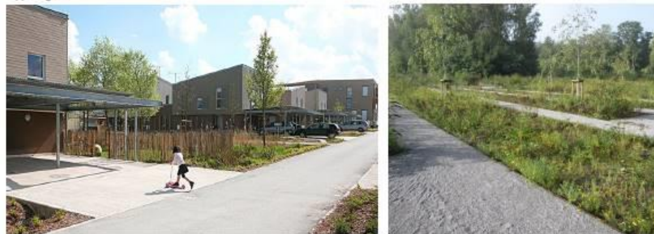
voie bordée d'une noue
